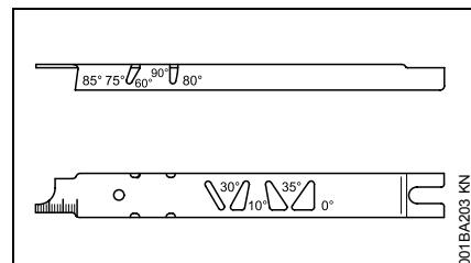
Utilice un calibrador de rectificación STIHL (accesorio especial – vea la tabla "Herramientas de afilado"). Esta es una herramienta universal para revisar los ángulos de rectificación y de la placa lateral, el ajuste de los calibradores de profundidad, el largo de los cortadores y la profundidad de la ranura. Además, limpia la ranura de la espada y los agujeros de entrada de aceite.
