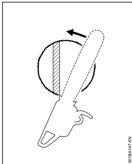
Enganche las púas de tope de la motosierra directamente detrás del eje de inclinación del árbol previsto y haga girar la sierra alrededor de ese punto solamente hasta el eje. La púa de tope rueda contra el tronco.
