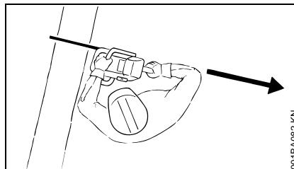
Coloque la motosierra en una posición tal que el cuerpo esté lejos del accesorio de corte cuando el motor está funcionando. Sitúese a la izquierda del corte mientras está tronzando.
