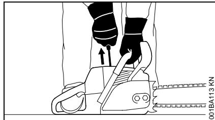
Con el **primermétodo** recomendado, la motosierra se arranca apoyada en el suelo. Asegúrese que el freno de la cadena esté aplicado (vea el capítulo "Freno de la cadena" en el manual de instrucciones) y apoye la motosierra sobre terreno firme u otra superficie sólida en un lugar abierto. Mantenga el equilibrio y elija un buen punto de apoyo para los pies.
