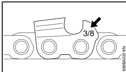
El paso de la cadena (por ejemplo: 3/8 pulg) se encuentra marcado en el lado del calibrador de profundidad de cada cortador.
