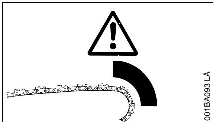
La gran fuerza utilizada para cortar madera puede cambiar de sentido y actuar contra el operador. Si una cadena en movimiento se detiene repentinamente al tocar un objeto sólido como por ejemplo un tronco o rama, o bien queda aprisionada, pueden presentarse de inmediato las fuerzas reactivas. Esas fuerzas reactivas pueden causar la pérdida del control, lo que a su vez puede causar lesiones graves o mortales. Una buena
